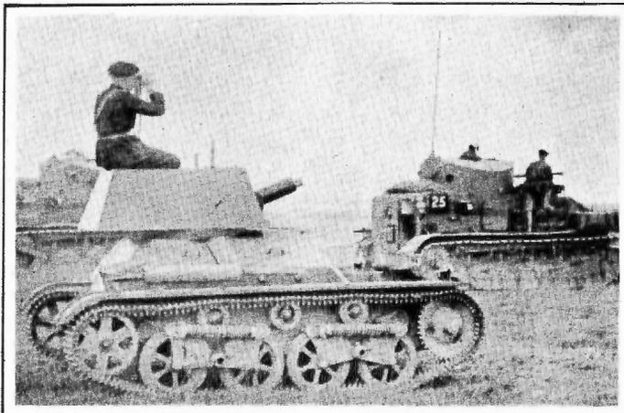
LOS TANQUES INGLESES.—Nuevo modelo de tanque ligero, incorporado recientemente al ejército inglés. Tiene alta velocidad, monta una pequeña pieza de artillería y se le destina al servicio de descubierta.
